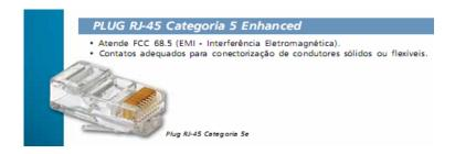
Conectores modulares de 8 posições do tipo RJ45 macho. Os contatos do conector devem ter um banho de 50 micropolegadas de ouro sobre 100 micropolegadas de níquel. Os contatos devem estar adequados para conectorizações de condutores sólidos e flexíveis;
